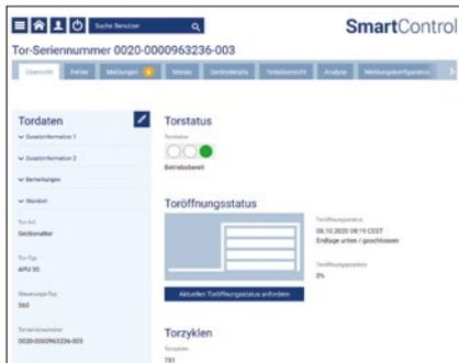
Además, la actual generación de puertas seccionales industriales se puede integrar en conceptos de servicio digital y mantenimiento remoto. Con el portal en línea SmartControl, usted recibe sin preocupaciones el paquete integral para procesos logísticos estables de forma permanente relacionados con su instalación de puerta. De esta forma, los tiempos de inactividad se reducen al mínimo gracias a la sustitución temprana de las piezas de desgaste.
